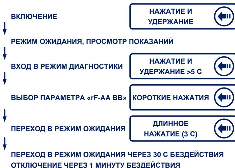
Рисунок 8 – Переход в режим диагностики и просмотр уровня сигнала
