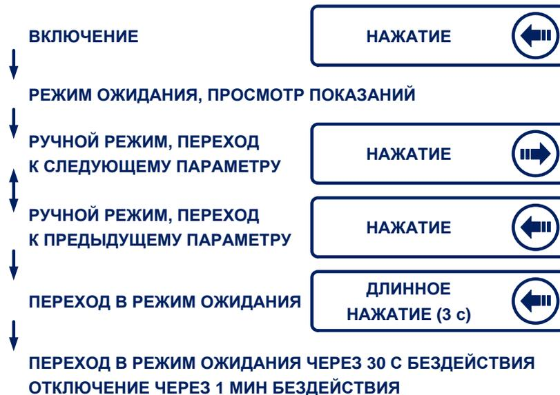
Рисунок 3 – Переход между параметрами в ручном режиме
