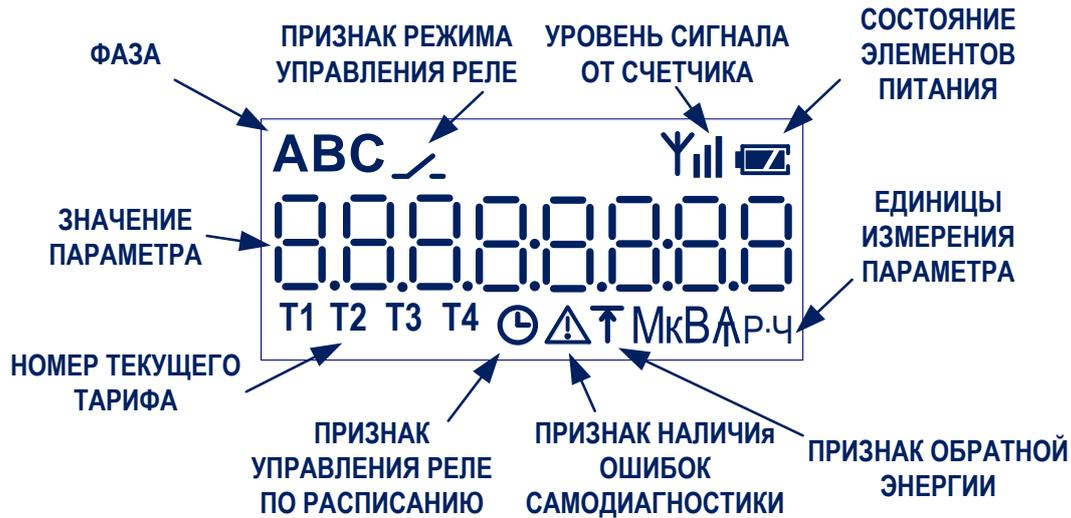
Рисунок 2 – Внешний вид и назначение сегментов индикатора дисплея
