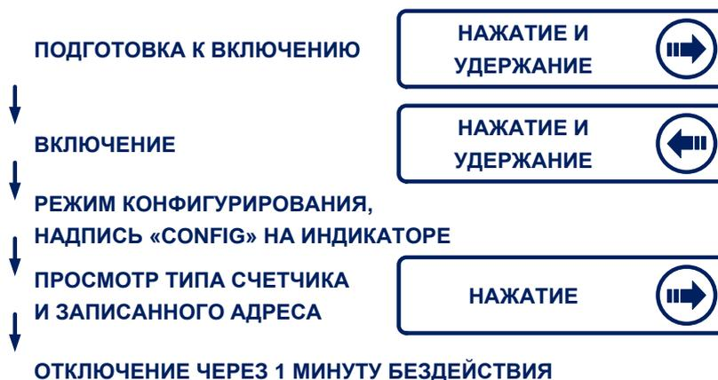
Рисунок 7 – Управление в режиме конфигурирования
