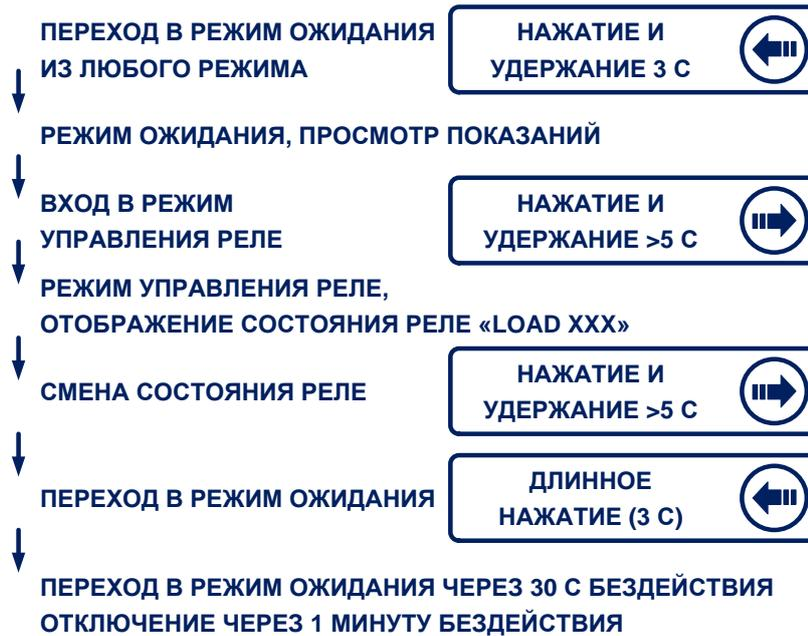
Рисунок 9 – Переход в режим управления реле и управление реле
